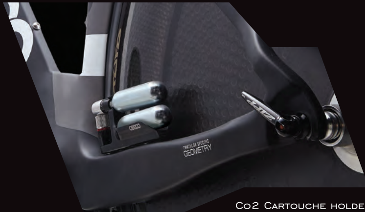
CO2 CARTOUCHE HOLDER HOLDER WEIGHT : 47G ADAPTOR WEIGHT : 22G
